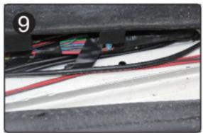
Подсоедините красный провод «В+» к положительной клемме (или к соответствующему предохранителю в предохранительной коробке), черный - к кузову авто, а желтый (АСС) - к зажиганию.
