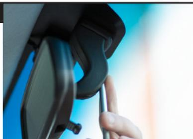
Снимите защитный чехол (при его наличии) с элемента крепления штатного зеркала заднего вида, открутите соответствующим инструментом кронштейн от металлического элемента крепления (пятак), который приклеен к лобовому стеклу
