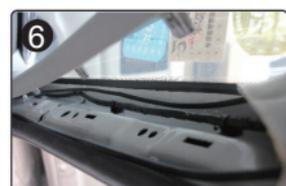
Подоткните кабель питания в зазоры между пластиковыми элементами (накладками) кузова и металлическими. Внимательно ознакомьтесь с местонахождением подушек безопасности в Вашем автомобиле и не допускайте попадания кабеля питания (и др.) на исполнительные механизмы подушек безопасности.
