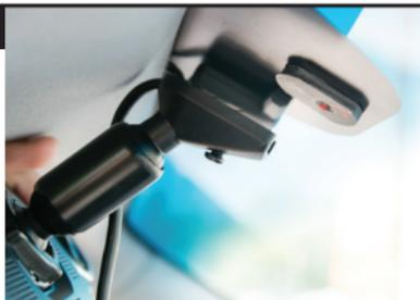
Прикрутите выбранный элемент крепления (кронштейн) к устройству четырьмя болтами, идущими в комплекте с устройством
