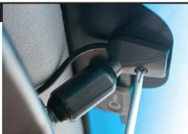
Закрутите болт (соответствующим инструментом) крепления кронштейна к пятаку
