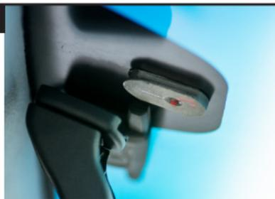
Снимите с направляющих пятака кронштейн вместе со штатным зеркалом заднего вида
